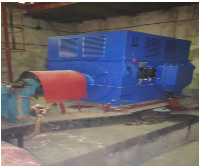
п.2.6. А4 сериясымен қорғалған қысқа тұйықталған роторы бар үш фазалы асинхронды электр қозғалтқышы
